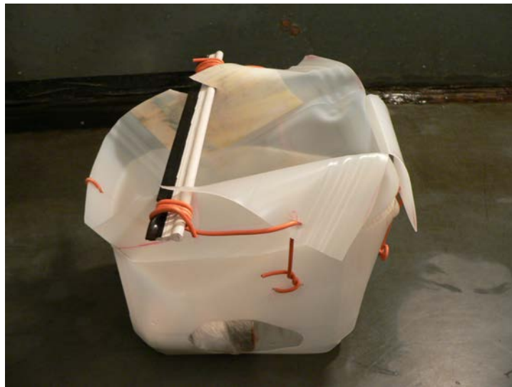
Ill. 5 : « MiniMadBox » version 1, machine fabriquée pour couler l'émulsion sur support film vierge, plastique, raclette à vitre, fil de fer. Séminaire Maddox III, MTK, Grenoble, 2016. Photo : Noémie Martin
